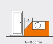
Die Wärmepumpen-Außeneinheit WLW MB AR enthält das Kältemittel R290, das eine höhere Dichte als Luft hat. Im Falle eines Lecks könnte sich das Kältemittel in Bodennähe ansammeln. Es muss daher verhindert werden, dass sich das Kältemittel in Nischen, Abflüssen, Spalten sonstigen Senken, Mulden oder Öffnungen ins Gebäude sammelt.
