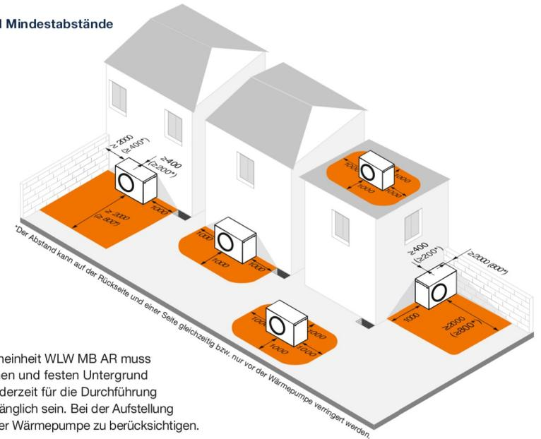
Die Wärmepumpen-Außeneinheit WLW MB AR muss im Freien auf einem ebenen und festen Untergrund aufgestellt werden und jederzeit für die Durchführung von Wartungsarbeiten zugänglich sein. Bei der Aufstellung ist der Schalldruckpegel der Wärmepumpe zu berücksichtigen.
